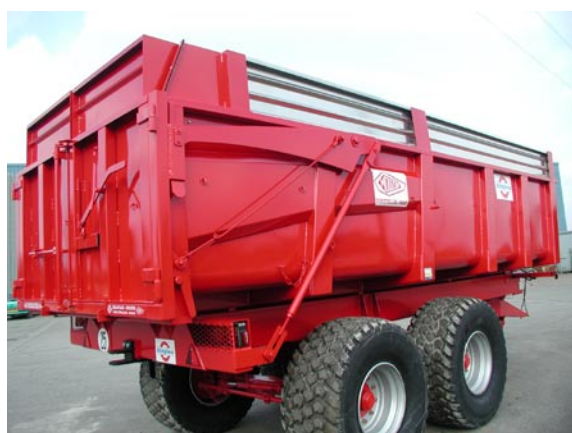
Remorque B160BV équipée de réhausseurs alu - Roues cargo 560/60/22.5
