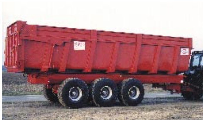
Remorque 24 tonnes équipée en pneus 20,5 x 20,5 Michelin.
