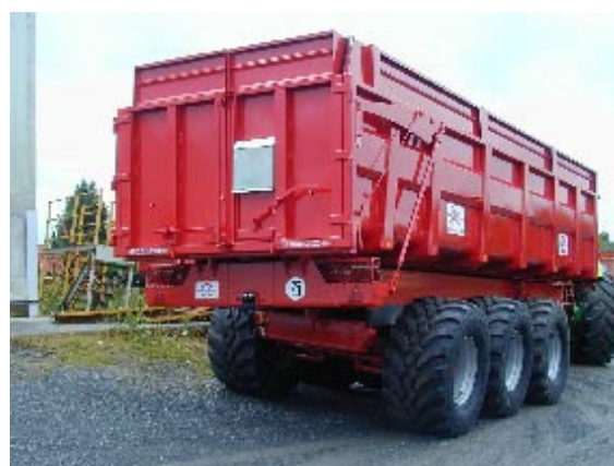
Remorque B240 TC, caisse 1,30 m, avec correcteur de dévers automatique
