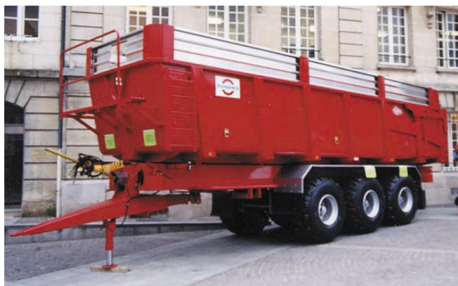
Bennage compas en standard sur 24 tonnes Bennage vérin et compas sur 18 tonnes
