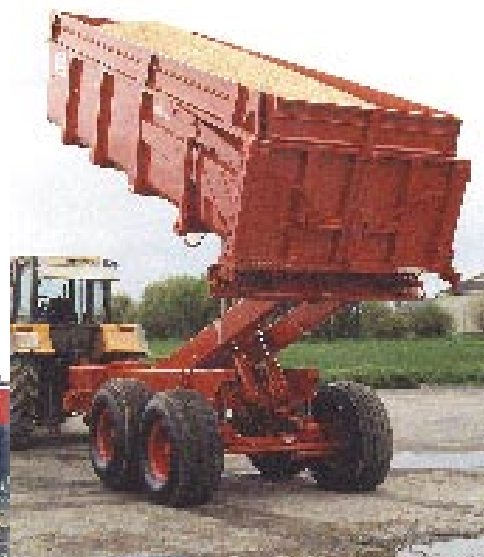
Remorque B160BV semi-élévatrice
