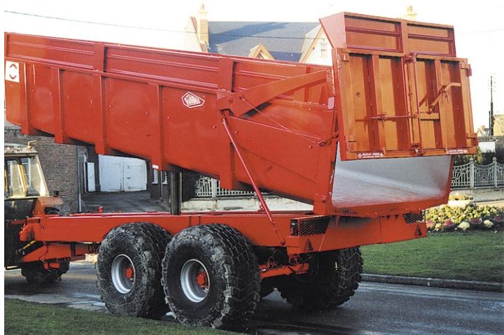
Structure de caisse en ranchers serrés - Châssis et structure de caisse à haute limite élastique
