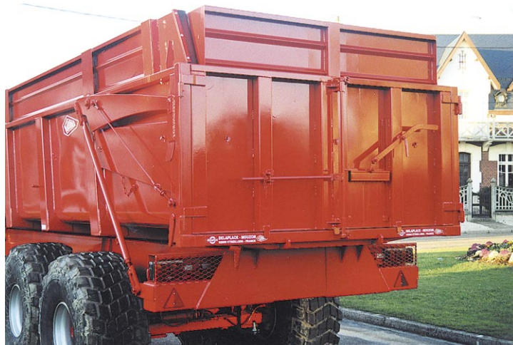
Porte arrière renforcée à double panneaux avec une trappe à grains de 400 x 400
