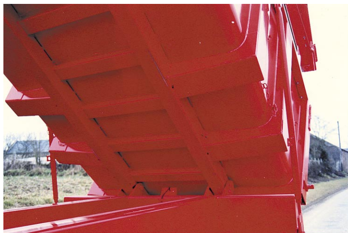
Traverses Omega sur tout le fond - Angles de rancher doublés par gousset - Soudure en continue
