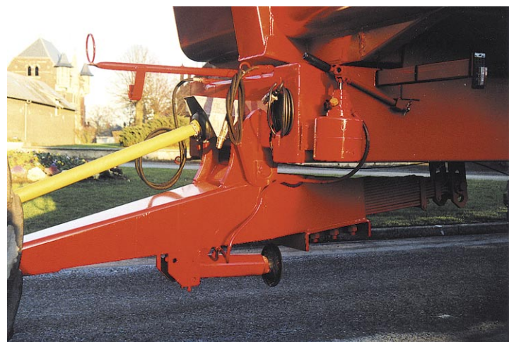
Flèche ressort à forte section caissonnée avec butées
