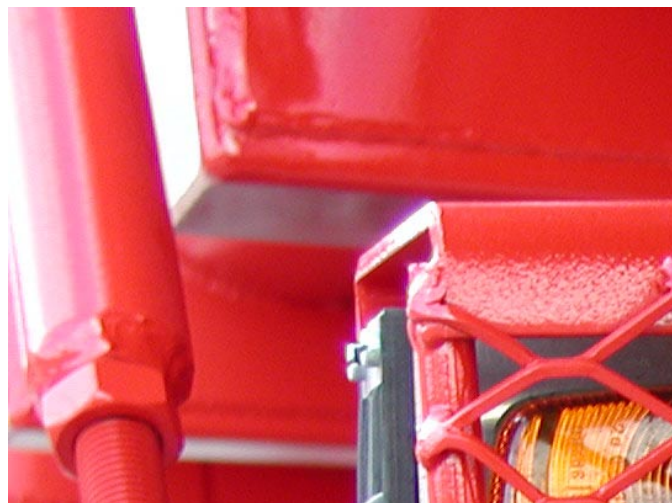
Double éclairage type "poids lourds" monté sur glissière
