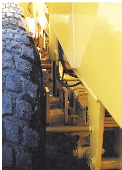
Essieu avant releveur sur tridem
