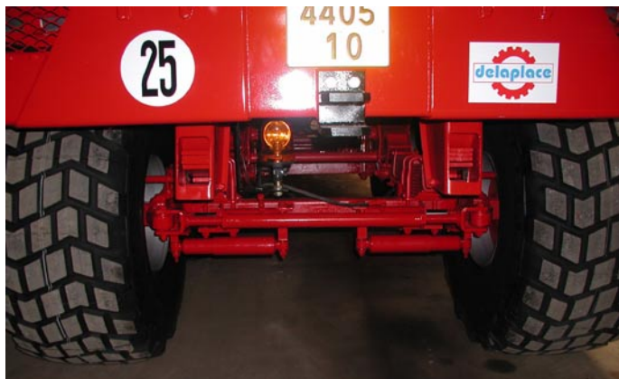
Essieu suiveur avec deux amortisseurs
