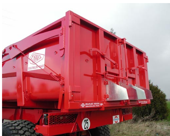
Porte articulée sur cadre - Guidage des crochets de verrouillage de sécurité par glissière
