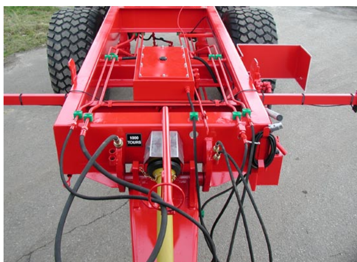
Compresseur 1000 tours et descente hydraulique
