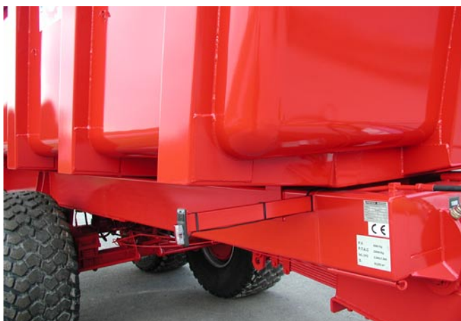
Angles arrondis, devant embouti avec rayon de 120 mm (évite le collage)
